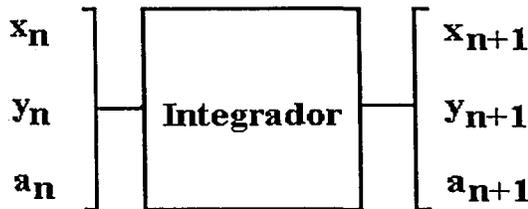
De acuerdo a la figura de arriba, el estado de un sistema de partículas en tiempo  $t_n$  (sólo se muestra el estado de una sola partícula para simplificar la notación) es alimentado al integrador. Este último nos entrega el estado del sistema en tiempo  $t_{n+1}$ . Ahora bien, el valor de la aceleración se calcula, en realidad, a partir de la fuerza neta que actúa sobre ella, esto es:
