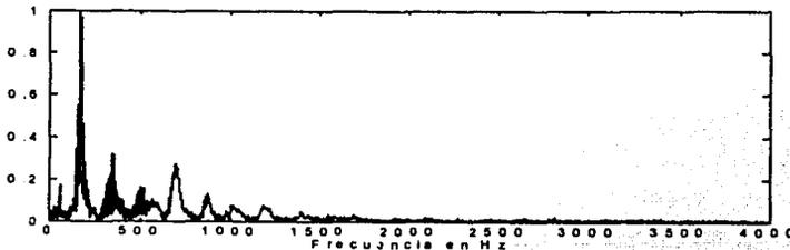
Figura 3.10. Espectro en frecuencia de la palabra "campo" en el cual se observa que la mayor información se concentra en los primeros 1000 Hz.
