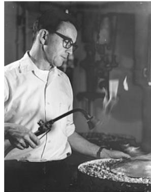
La fundición de la plata es el segundo paso para después laminar la plata.
