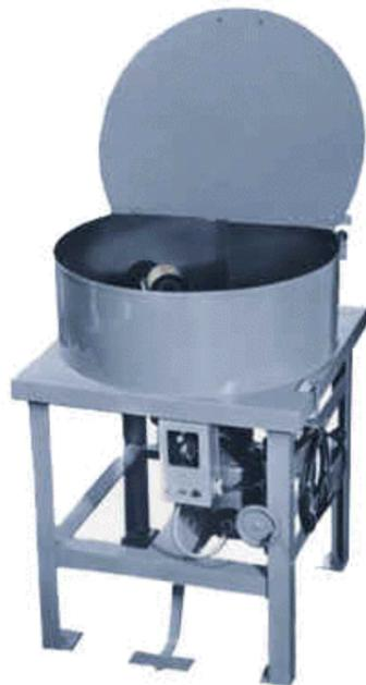
La centrífuga es una herramienta mecánica funcionando con motor. Mediante la fuerza potencial liberada se puede inyectar la plata en los moldes preparados para este fin. Esto se conoce también como proceso de "casting"
