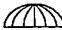
LUMINARIA FLUORESCENTE TIPO INDUSTRIAL CON REFLECTOR DE ALUMINIO, MOD. 100-CL-RR, MARCA ELMSA O SIMILAR
