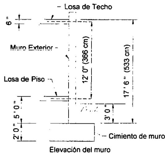
FIGURA 10.1 SECCIÓN TRANSVERSAL DE MURO
