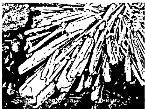
Figura 3.28. Acercamiento donde se puede observar un crecimiento laminar en la superficie de las fibras.
