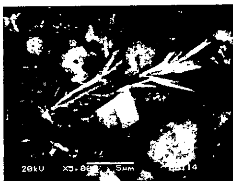
Figura 3.73. Acercamiento a unos cristales que presentan un crecimiento con ramificaciones.
