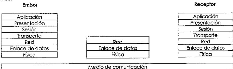
Figura 1.1 Capas del Modelo OSI
