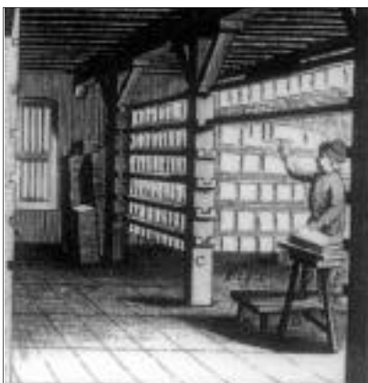
Las hojas resultantes se colgaban en desvanes o naves para que se secan
