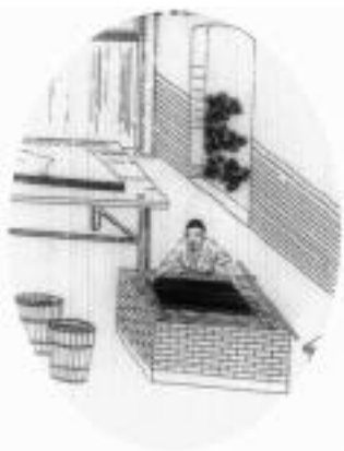
En la rejilla de bambú se depositaba una fina capa de fibras que formaban la hoja.
