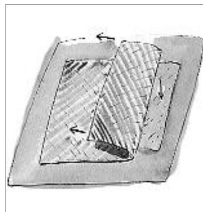
paso 6. En una manta seca se despega la hoja de la manta mojada.
