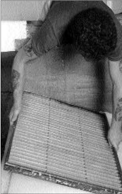
El pliego de papel se transfiere al fieltro. Se hacen capas de fieltro-papel-fieltro.
