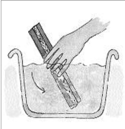
paso 3. Se sumergen la forma y el molde en la tina sujetandose con firmeza. Esto debe hacerse suavemente.
