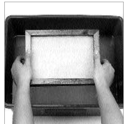
paso 8. se retira cuidadosamente de la tina el molde y la forma.
