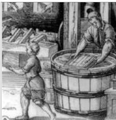
En la pulpa de madera "la forma" que se utilizaba tenía malla metálica
