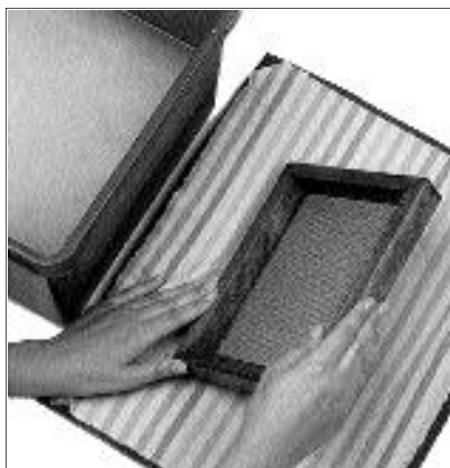
paso 2. Se transfiere la hoja recién hecha a una manta seca.
