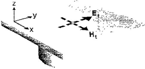
Figura 2.9 Representación de una apertura en  $z=0$ , con presencia de campo eléctrico y magnético tangenciales
