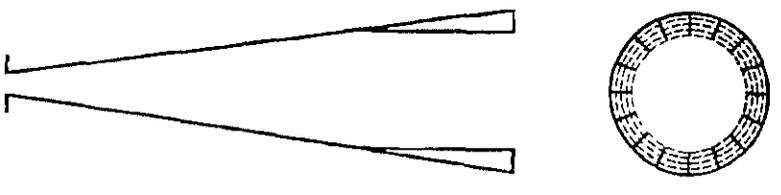
Figura 3.50 Geometría de una antena de corneta cónica con corrugaciones longitudinales rellenas de material dieléctrico
