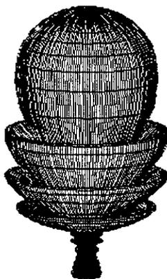
Figura 5.16 (b) Patrón de radiación tridimensional polar de una antena de corneta corrugada de dimensiones  $A=5\lambda$  con error de fase máximo  $\delta=0^\circ$  (guía de ondas corrugada).
