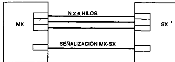
Figura 21. Circuitos de enlace MX-SX
