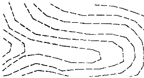
Fig. 5.2 Trazo de curvas de nivel en el proceso de restitución.
