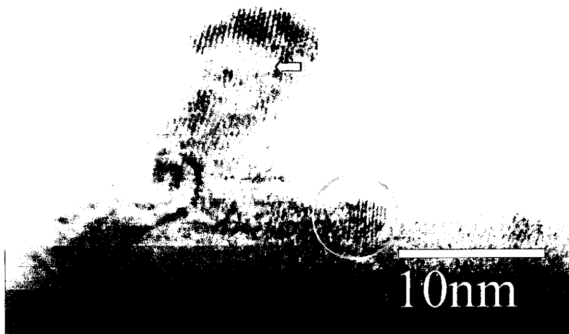
Figura 4.44. Imagen de alta resolución de la aleación NiAl+6%at.Mo, observándose un defecto y distancias interplanares de la matriz NiAl.
