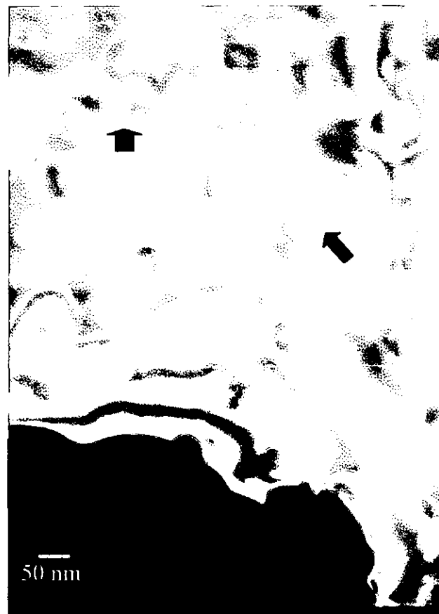
Figura 4.45. Imagen de campo oscuro de la aleación NiAl+6Fe2Mo(%at.) después del proceso de sinterización.
