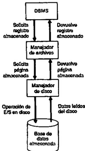
Fig. 2.9 El DBMS, el manejador de archivos y el manejador de disco
