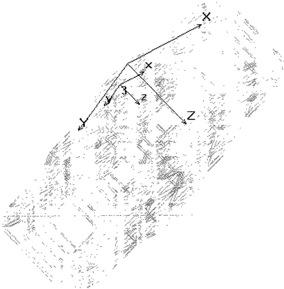
Fig. 5.3 Geometría representativa del caso de estudio, celdas hexagonales de honeycomb, con placas de fibra de vidrio embebidas en resina poliéster.
