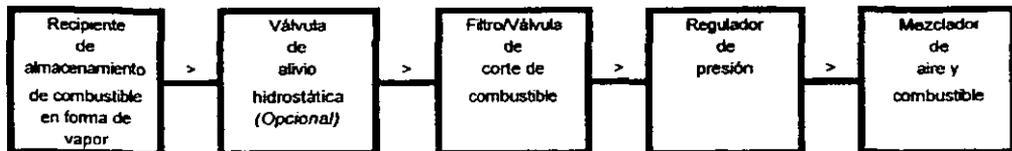
Figura 2.6 extracción de GLP en forma de vapor.
