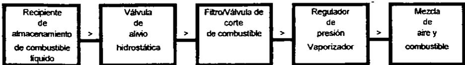
• Figura 2.6 Extracción de GLP en forma líquida.
