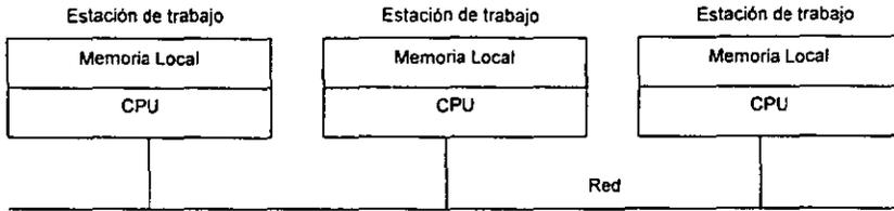
Figura 10. Multicomputadora que consta de estaciones de trabajo en una LAN
