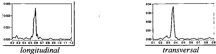
Fig 8.7. Espectros de potencia para el cálculo del amortiguamiento.
