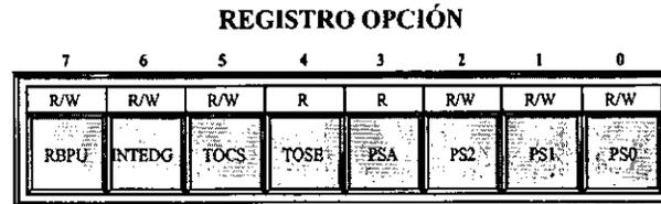
**Figura 2.12 Estructura interna del registro OPCÓN.**
