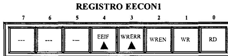
**Figura 2.10 Distribución de los bits del registro EECON1.**
