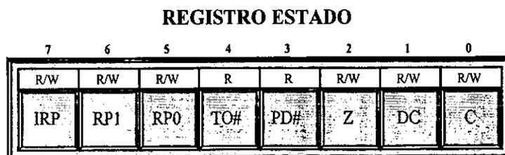
**Figura 2.11 Estructura interna del registro ESTADO.**
