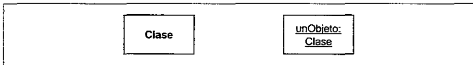
Figura 1-12 Ejemplo del uso de formatos (adornments) para distinguir entre una clase y un objeto.
