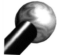
Las conexiones se hacen uniendo la esfera con un extremo de la barra para hacer que el imán entre en contacto con el metal de la esfera y se asegure la unión como vemos en la imagen 2.
