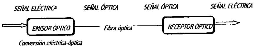
Fig.1.1 conversión de señal eléctrica - óptica, óptica - eléctrica
