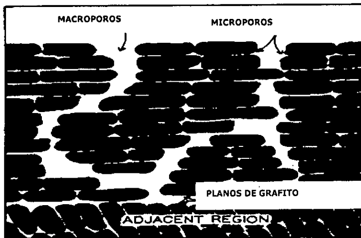
Figura 1.7. Diagrama idealizado de la estructura porosa de un carbón activado
