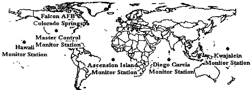
Fig. 5.15 Control Maestro y Monitoreo de Estaciones de Trabajo del Sistema de Posicionamiento Global (GPS)
