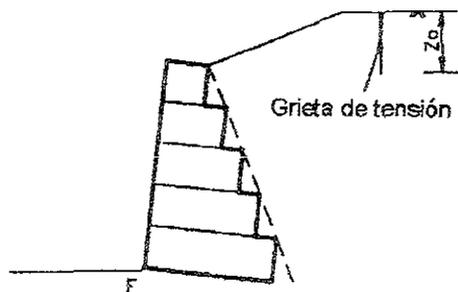
Figura 21. Grietas de tensión en terraplén cohesivo.
