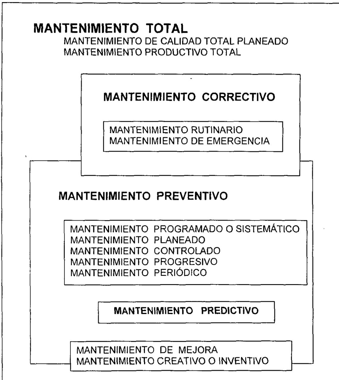
Figura 2.3 Tipos de mantenimiento.
