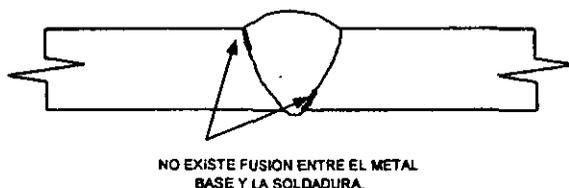
Figura 14 - Falta de Fusión en cordón de Raíz o parte Superior de la Soldadura (FF)
