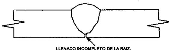
Figura 12 - Falta de Penetración sin desalineamiento (FP)
