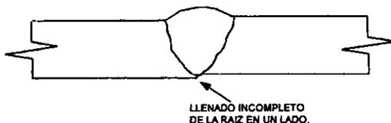
Figura 13 - Falta de Penetración debida a Desalineamiento (FPDT)
