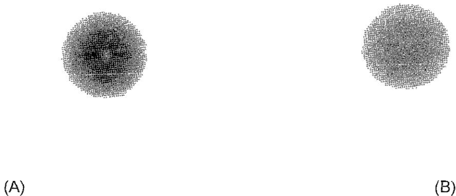
Figura-4. 1. Imágenes digitalizadas mostrando la dimensión del isocentro bajo movimiento dinámico, usando película Gafchromic. (A) movimiento de la camilla y (B) movimiento del cabezal.
