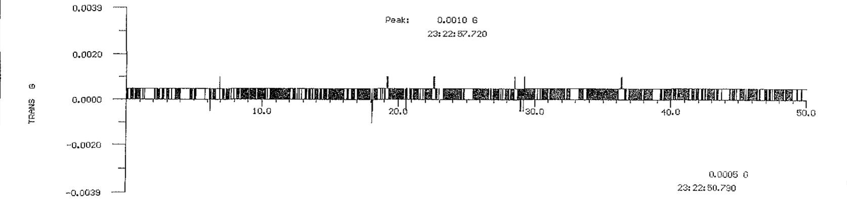
Fig. 5.6 Registro de aceleraciones, obtenido en el equipo ubicado en el sótano, para la señal AESO6801.
