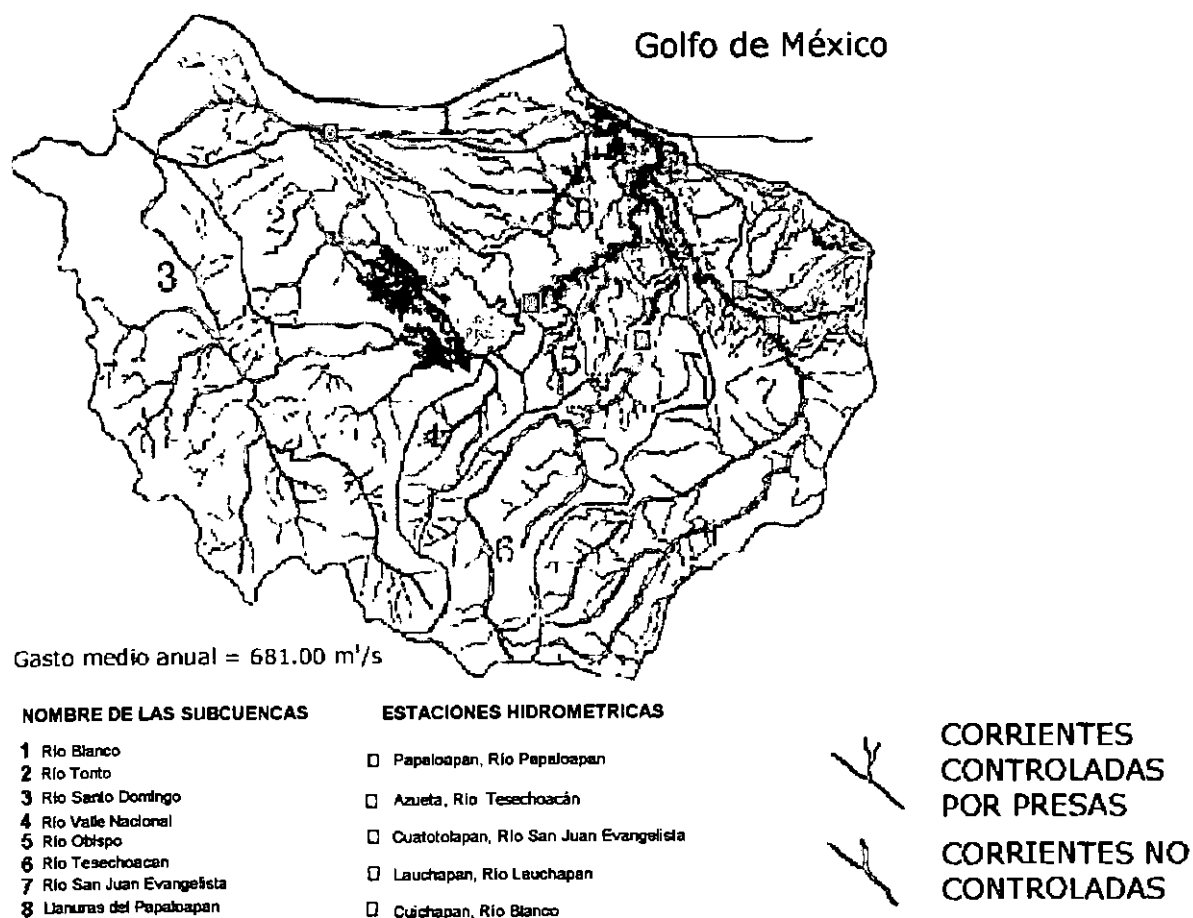
Figura 11. Representación de las subcuencas, corrientes controladas y no controladas del Río Papaloapan, así como de las estaciones hidrométricas utilizadas en el presente trabajo.
