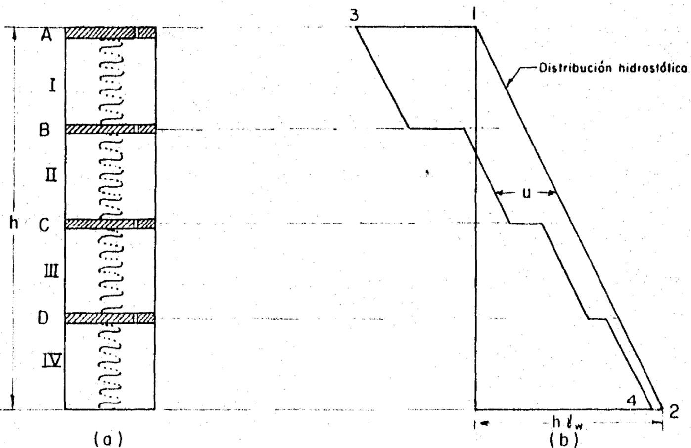
Fig. 2. Analogía de una masa de arcilla saturada expuesta a evaporación superficial.
