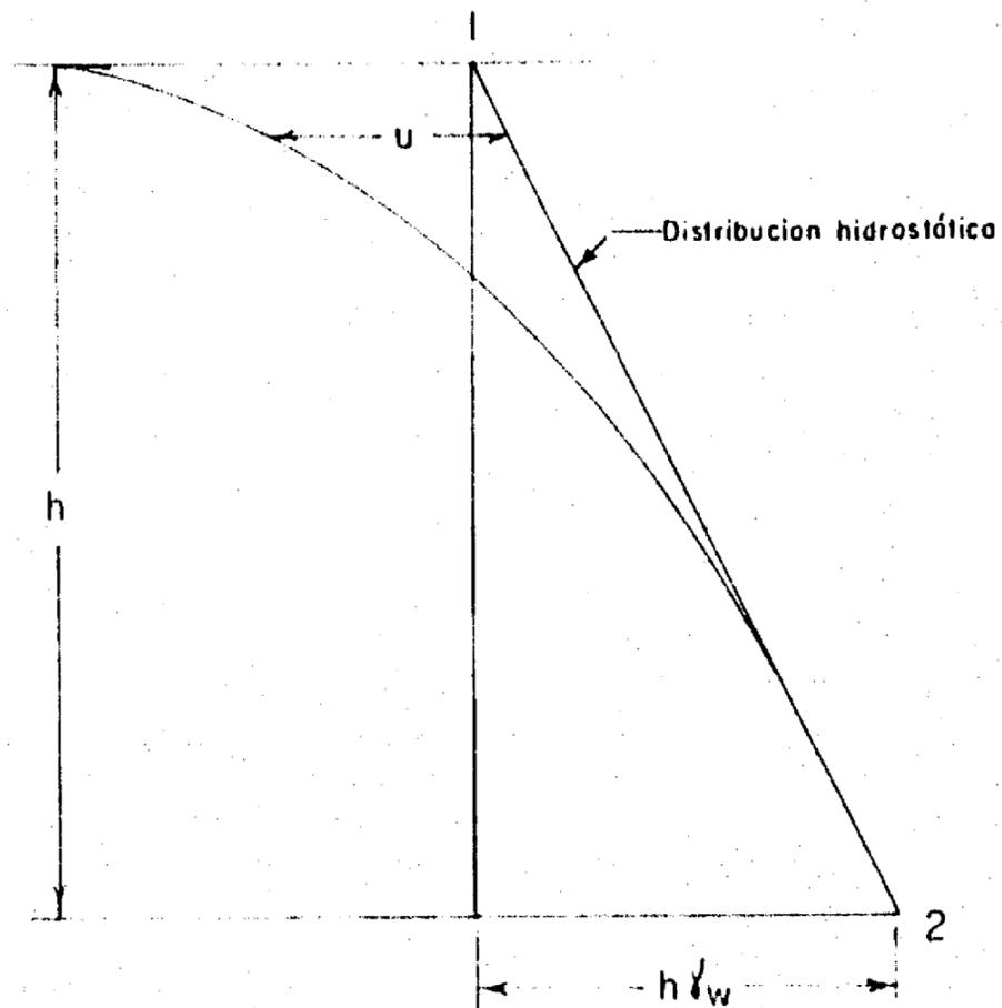
Fig. 3. Forma de la distribución de las tensiones neutras producidas por la evaporación superficial en una masa de arcilla saturada.
