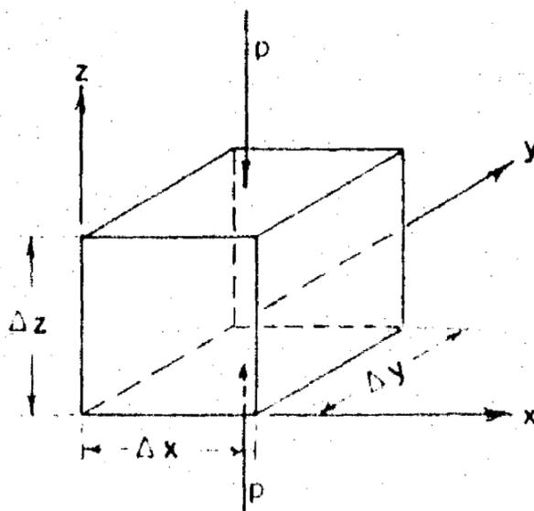
Fig. 8. Volumen cúbico elemental no confinado de arcilla saturada sometido a la presión exterior  $p$
