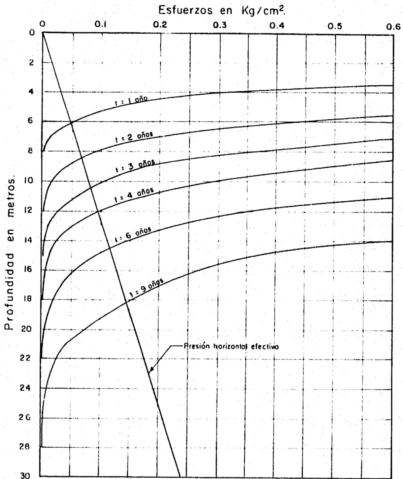
Fig. 10. Gráfica de las tensiones horizontales efectivas inducidas en función de la profundidad a distintos tiempos en la arcilla saturada del lecho del antiguo lago de Texcoco.
