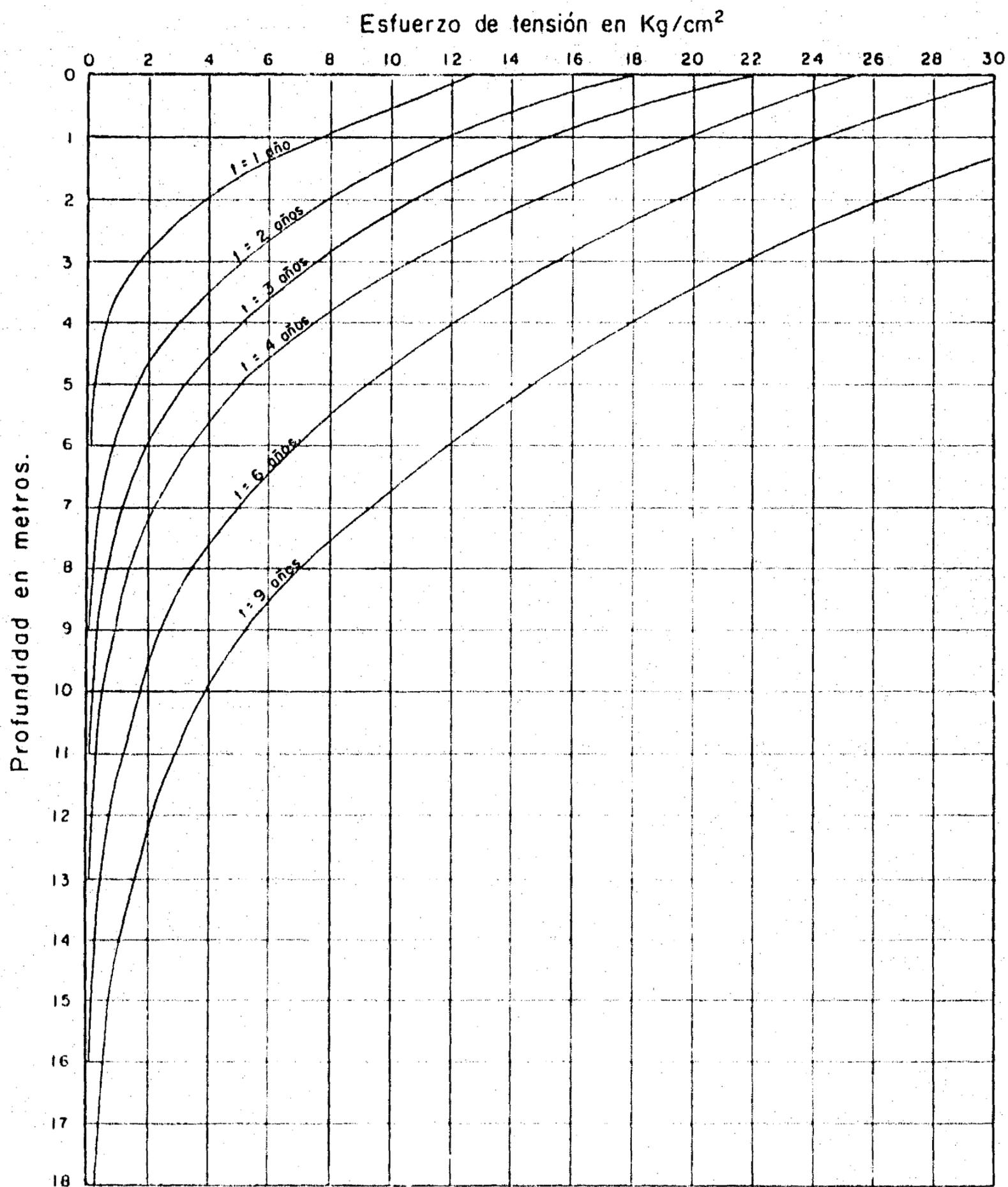
Fig 9. Gráfica de las tensiones neutrales inducidas por evaporación superficial en función de la profundidad a distintos tiempos en la arcilla saturada del lecho del antiguo lago de Texcoco.
