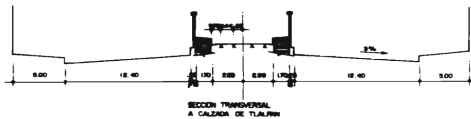
FIG. II. B. I. I. SECCION TRANSVERSAL DE LA ESTRUCTURA (proyecto) Y CALZADA DE TLALPAN.
