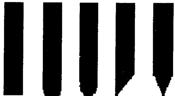
Diferentes perfiles de la hoja de rasero, cada uno de los cuales distribuye la tinta de diferente forma.
