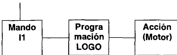
Fig. 3.3.2. Etapas del circuito de arranque y paro.
