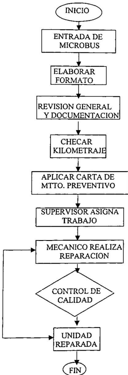
DIAGRAMA DE FLUJO: MANTENIMIENTO CORRECTIVO.
