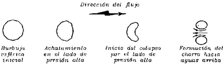
b) Burbuja moviéndose en el gradiente de presión (como el flujo en un difusor tipo Venturi)
