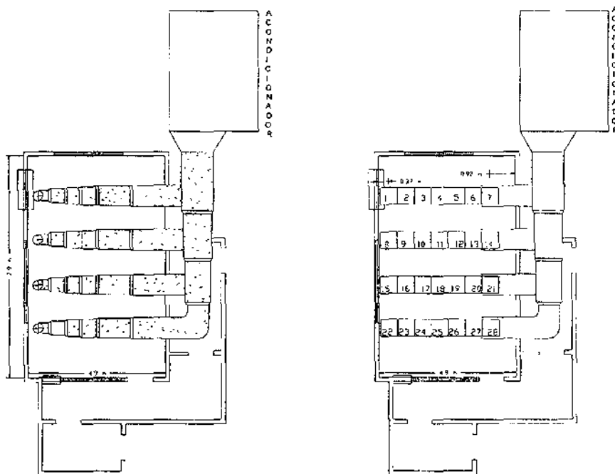
Fig. 4.10 Ubicación de filtros absolutos en la sala de envasado de leche en polvo
