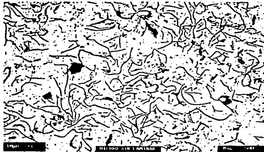
Figura I. 5 Imagen correspondiente hierro gris clase 30 con grafito tipo A. amplificación 500X
