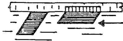
f) Con coladera múltiple de banqueta, piso y banqueta.
