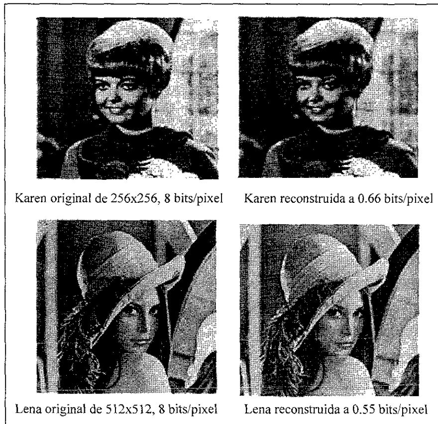
Figura 2.22. Imágenes originales comprimidas con codificación sub-banda. Imagen reconstruida de Karen con SNR de 33.78 e imagen reconstruida de Lena con SNR de 33.95 (GHARAVI, Hamid, TABATABAI, Ali. "Sub-band coding of monochrome and color images").
