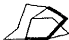
Figura 2-11 Ejemplo de enlaces estratégicos en un sistema puenteado. Si se desconecta cualquiera de los enlaces marcados, se obtiene una estructura fusionada simple
