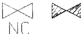
Además, al insertar una válvula deberá ser opcional el desplegar la leyenda NC ya que puede ser una válvula en la que se quiera representar únicamente el diámetro o se requieran ambos datos. En la figura IV.7 se muestra como puede ser la representación de estos datos, normalmente en un gráfico horizontal los datos se muestran bajo este y en uno vertical se tienen dos opciones.
