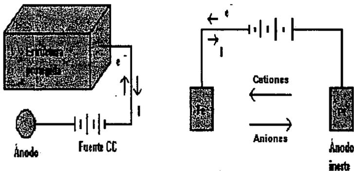
Fig. 1.5 Protección catódica por corriente impresa.[1].
