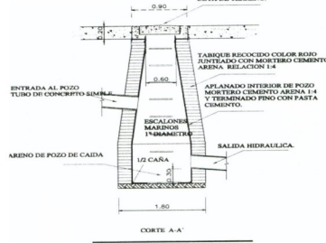
ALZADO DE POZO DE CAIDA.
