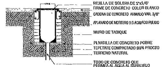
DETALLE REGISTRO AGUAS PLUVIALES ESCALA GRAFICA 0.00 0.20 0.40 0.60 0.80 1.00
