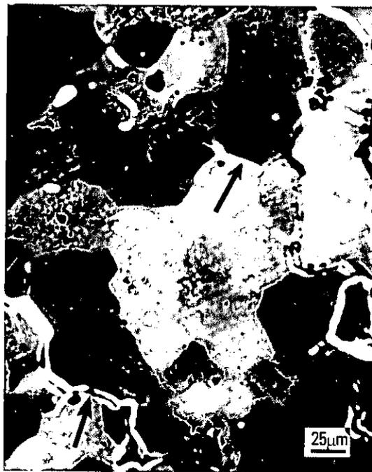
Figura 3.5 Propagación de la grieta a lo largo de las fronteras de grano externas en una muestra forjada.
