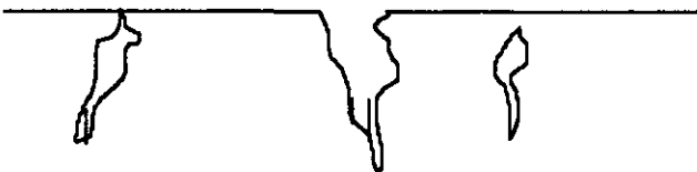
Figura 5.3.- Limpieza excesiva del penetrante.
