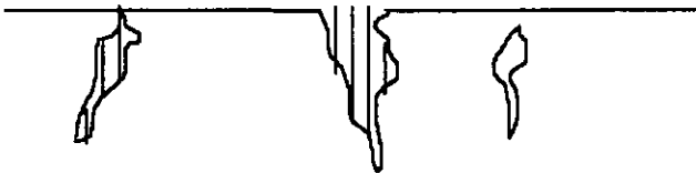
Figura 5.2.- Remoción del exceso de penetrante.
