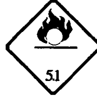
DIVISION 5.1 SUBSTANCIAS OXIDANTES SIMBOLO (FLAMA SOBRE UN CIRCULO): NEGRO FONDO: AMARILLO. CIFRA "5.1" EN EL ANGULO INFERIOR PODRA LLEVAR LA LEYENDA "OXIDANTE"
