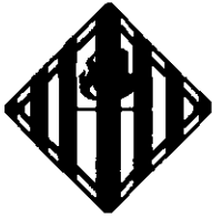
DIVISION 4.1 SOLIDOS INFLAMABLES SIMBOLO (FLAMA): NEGRO FONDO: BLANCO CON SIETE FRANJAS ROJAS VERTICALES. CIFRA "4" EN EL ANGULO INFERIOR PODRA LLEVAR LA LEYENDA "SOLIDO INFLAMABLE"
