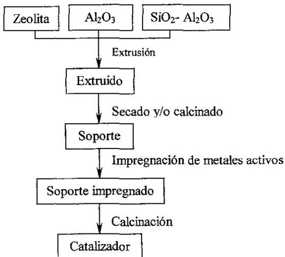
Figura 5. Diagrama típico de preparación de catalizadores para HDI.<sup>[1]</sup>
