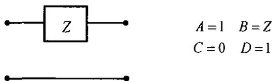
Figura 3.8. Impedancia y su representación por parámetros  $ABCD$ .
