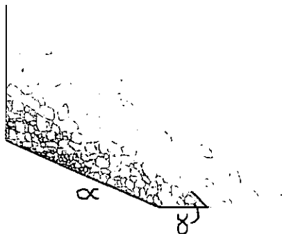
Fig. N° 26 Recomendación para evitar desgaste en una tolva
